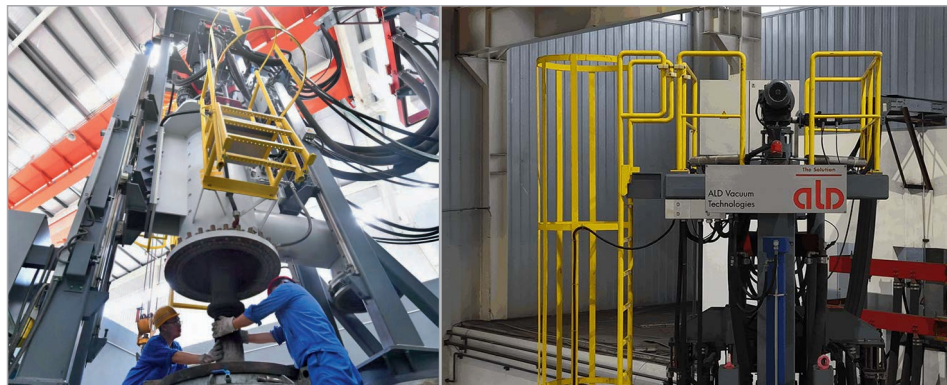
▶ ドイツから輸入 ALD 真空溶解炉 ALD vacuum melting furnace imported from Germany
