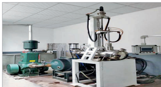
▶ 5kg 実験用 VAR 溶解炉 5kg VAR melting furnace for testing
